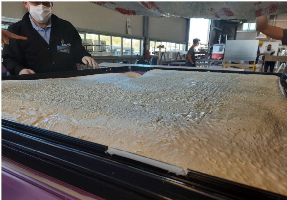
Figure 9 Spandrel part – Eensulate foam
